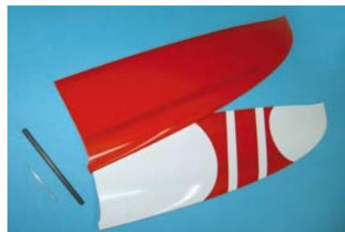
**Das Höhenleitwerk ist, wie alle Teile, nur dünn lackiert. Bei so einem Modell zählt jedes Gramm. Deutlich zu sehen auch der CFK-Holm zur Versteifung des Ruders**
