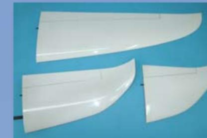
**Die drei Flächenaußenohren für 3.390, 3.630 und 3.950 Millimeter Spannweite machen den Orca4x universell einsetzbar. Befestigt werden die Ohren mit einem Streifen Klebeband**
