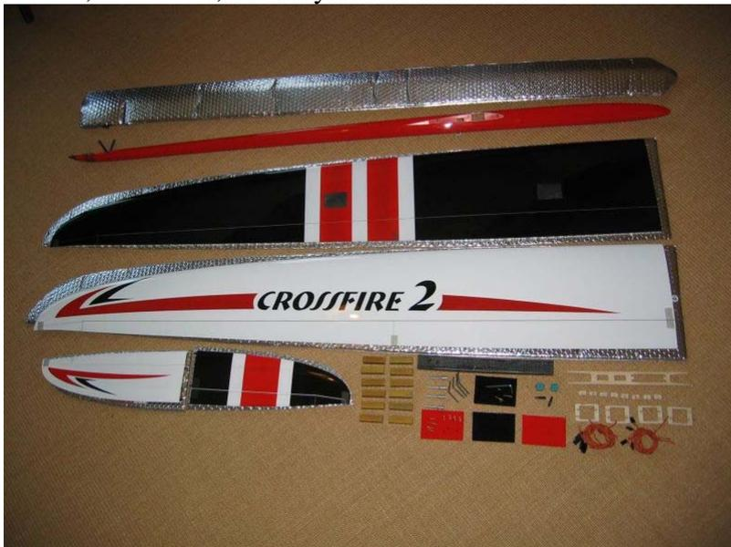
Ballast(1,6 kg), Kabel, Stecker, Löthülsen, Gabelköpfe, Servoabdeckungen, RDS-system, Servorahmen für s3150, Servobrett Rumpf, Carbonverbinder.
