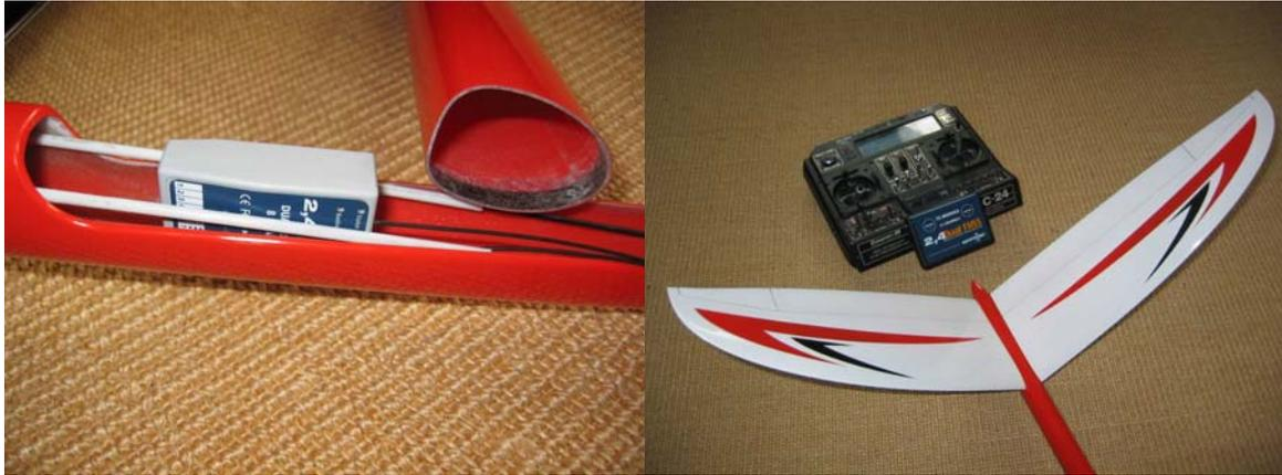
Der Rumpf ist sehr dünn (Breite 34mm/Höhe 49mm), durch den speziellen Querschnitt passt jedoch sogar der WEATRONIC 2.4 8K-Empfänger problemlos hinein !In der Serie ist der Rumpf mit einem entsprechenden Servobrett vorbereitet!
